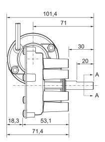
Dimensões em milímetros. Tolerâncias lineares não especificadas  $\pm$  0,5 mm. Tolerâncias angulares  $\pm$  0,5°. Sujeito a alterações sem aviso prévio.
