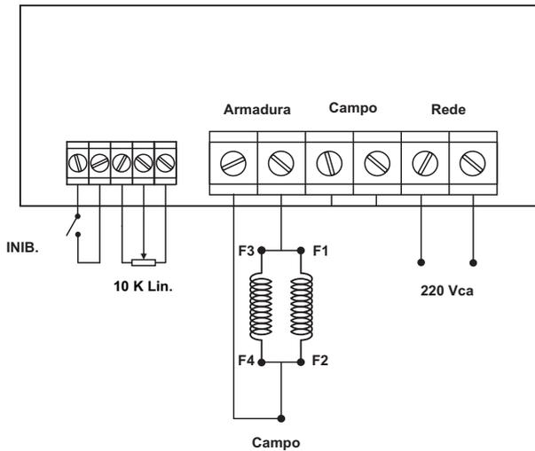
Ligado como **FREIO** corrente contínua excitação shunt com CVE 1501 controlando a corrente de excitação
