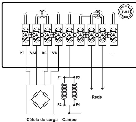
Ligado como **FREIO** corrente contínua excitação shunt com CVE 1707 controlando a tensão de excitação tendo como referência sinal da célula de carga
