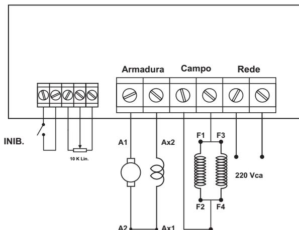
Ligado como **MOTOR** corrente contínua excitação shunt com CVE 1502
